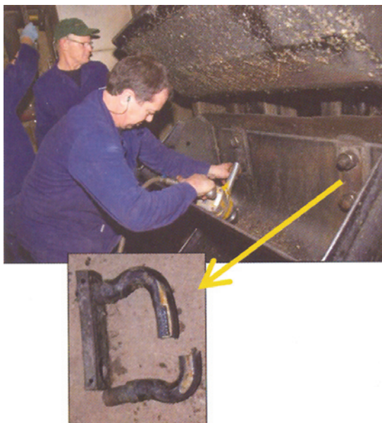
شکل شماره ۱۰: تعمیر الواتور چغندر در Volverlaten
