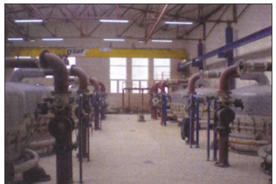
شکل شماره ۷: مدرن کردن کارخانه قند استرژین (سپتامبر ۲۰۰۸): مخازن شولاژ اصلی و کربناتاسیون (در بالا) و قسمت صاف کردن شربت
